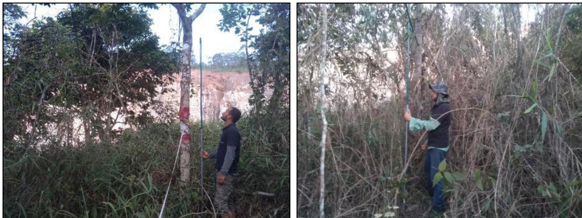
Figura 38: Imagem da medição da HT de indivíduo arbóreo, com destaque para a régua hipsométrica graduada, durante a execução do Inventário Florestal.
