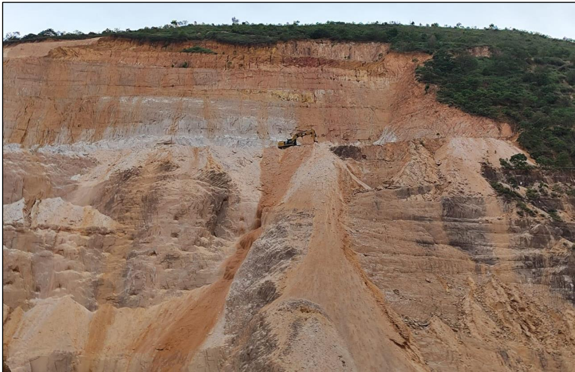
Figura 26: Escavação do material mineral em frente de lavra. Fonte: Ecolabore Engenharia (2024).
