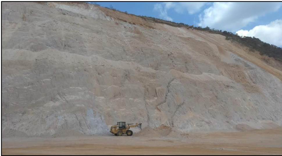
Figura 25: Frente da lavra com formação das pilhas de areia. Fonte: Ecolabore Engenharia (2024).
