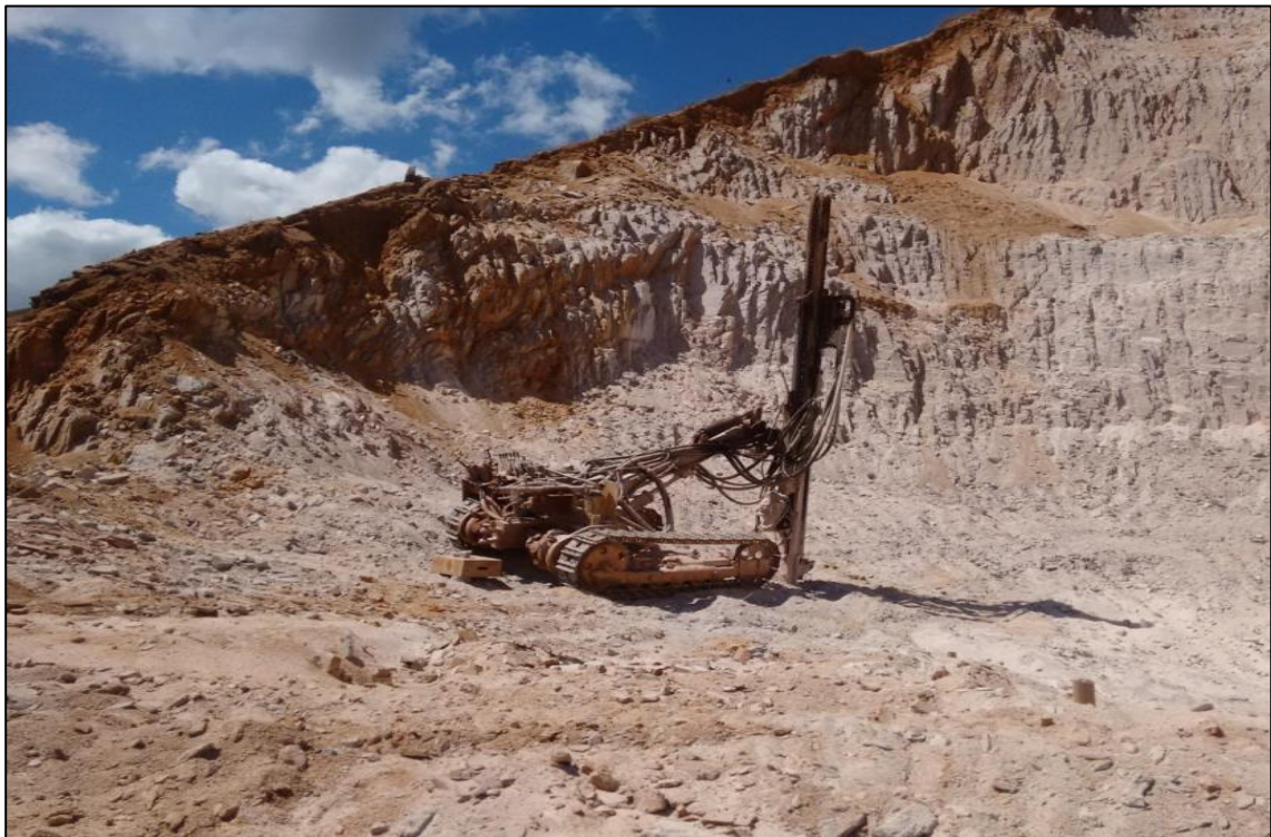
Figura 27: Perfuratriz sobre esteiras usada na aplicação de explosivos. Fonte: Ecolabore Engenharia (2024).
