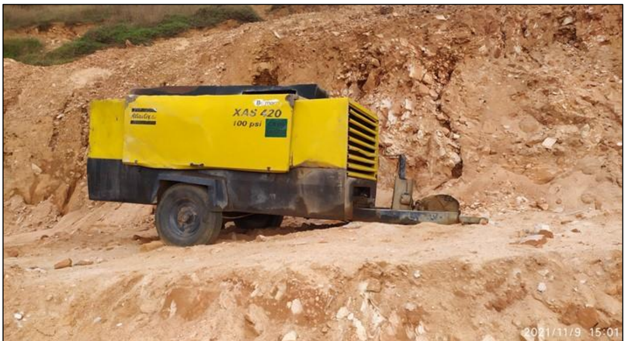
Figura 28: Compressor a diesel usado para acionar a perfuratriz sobre esteiras. Fonte: Ecolabore Engenharia (2024).
